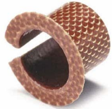
Bei den Hiplast-Gleitlagern handelt es sich um dünnwandige Multilayer-Lösungen, bestehend aus einem Mikrogeflecht aus Streckmetall und einer PTFE-Füllmasse, die zugleich die Gleitschicht bildet
