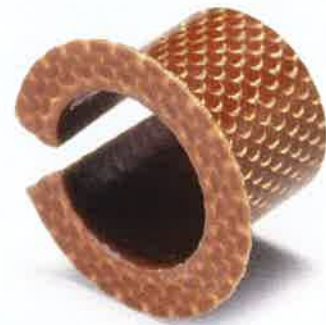
Abb. 3: Bei den Hiplast-Gleitlagern handelt es sich um dünnwandige Multilayer-Lösungen, bestehend aus einem Mikrogeflecht aus Streckmetall und einer PTFE-Füllmasse, die zugleich die Gleitschicht bildet.
